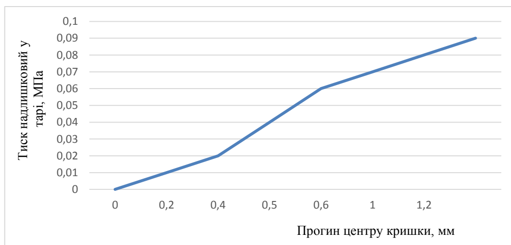
Рис. 5. Залежність прогину центру кришки (плівки) від величини надлишкового тиску для металевої тари з кришкою з полімерного матеріалу і двосекційної тари типу СРЕТ
