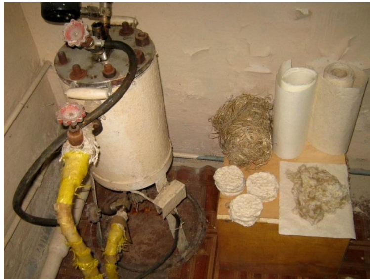
Рис. 1. Лабораторна установка ВК-1 для варіння целюлози
