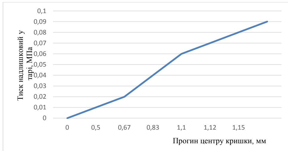
Рис. 6. Залежність прогину центру кришки від величини надлишкового тиску для полімерної напівжорсткої тари з кришкою з алюмінієвої фольги
