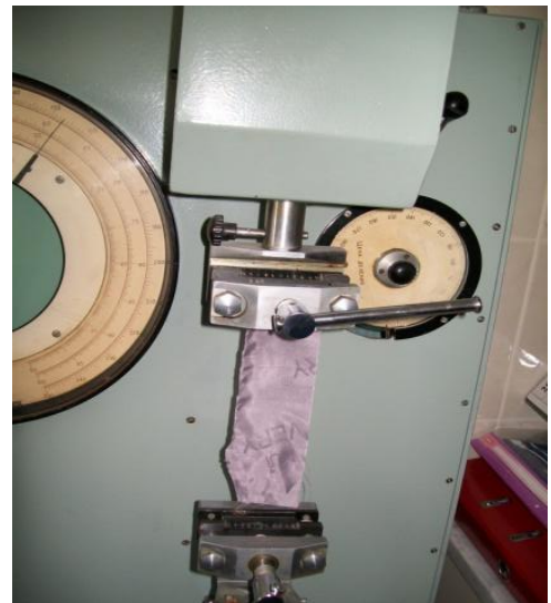
Рис. 7. Фотографічне зображення вимірювання розривального зусилля тканини підкладкової із синтетичних ниток фірми «Wujiang Xinhuali Textile Co., Ltd»
