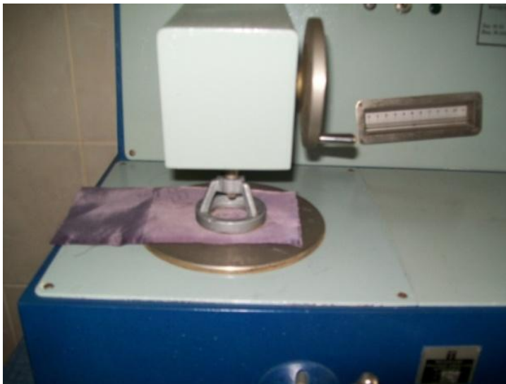
Рис. 6. Фотографічне зображення вимірювання показника повітропроникності тканини підкладкової
