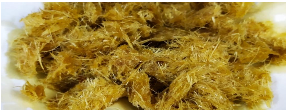
Рисунок 3. Технічна конопля після обробки 5% NaOH, протягом 90 хв
