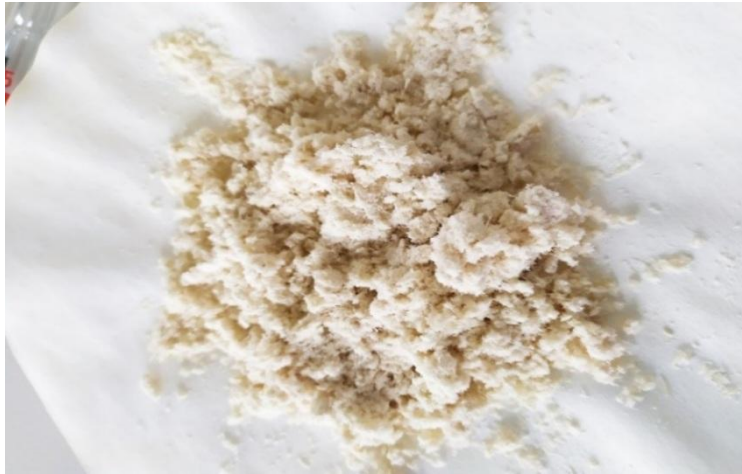
Рисунок 4. Волокна технічної коноплі після обробки трилоном Б
