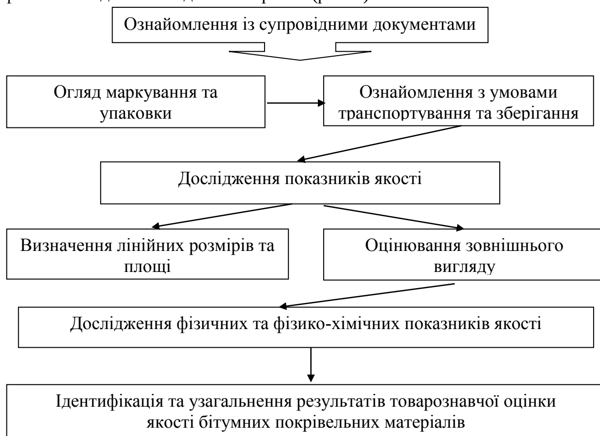
Рис. 1. Схема проведення товарознавчої оцінки якості покрівельних матеріалів
