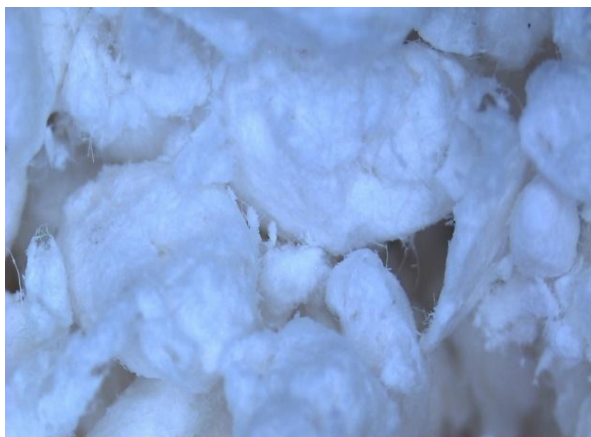
Рисунок 9. Целюлоза-3, подрібнена за допомогою гомогенізатора (фото з оптичного мікроскопа, збільшення 1,25 ×)
