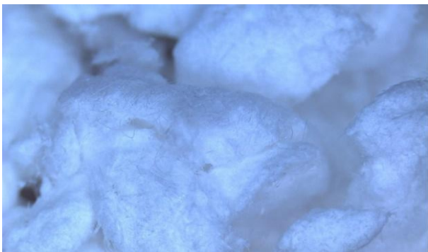
Рисунок 7. Целюлоза-2, подрібнена за допомогою гомогенізатора (фото з оптичного мікроскопа, збільшення 1,25×)
